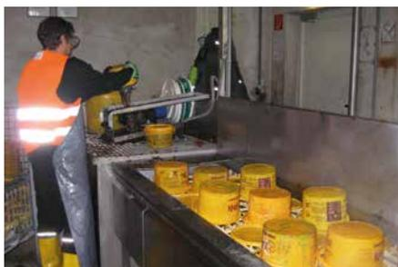
Bei der Fa. Münzer werden die NÖLIs dann händisch geöffnet und entleert. Das Öl rinnt in einen Auffangbehälter.
