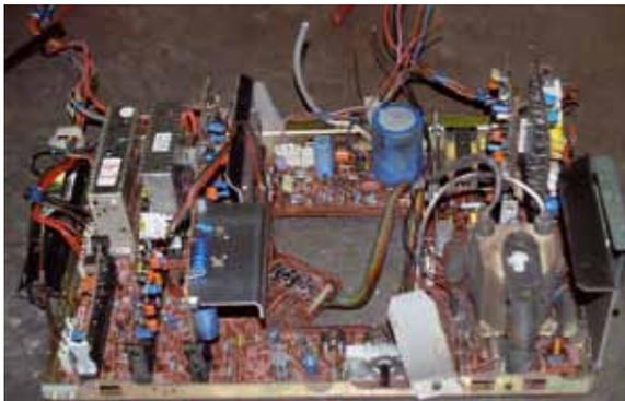
Leiterplatte mit Elektrolytkondensator (blauer Zylinder)
